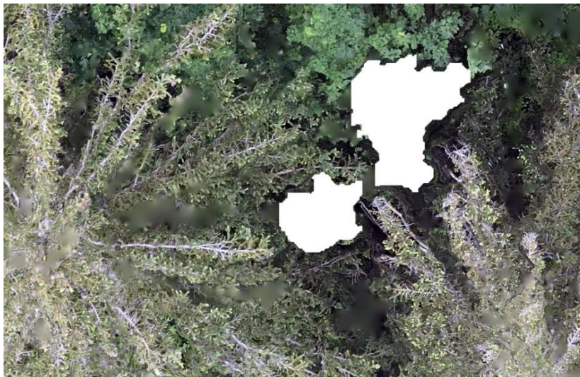
Abbildung 1: Artefakte im Zwischenkronenbereich mit unscharfen Orthomosaikbereichen und nicht rekonstruierbaren weißen Zonen.
