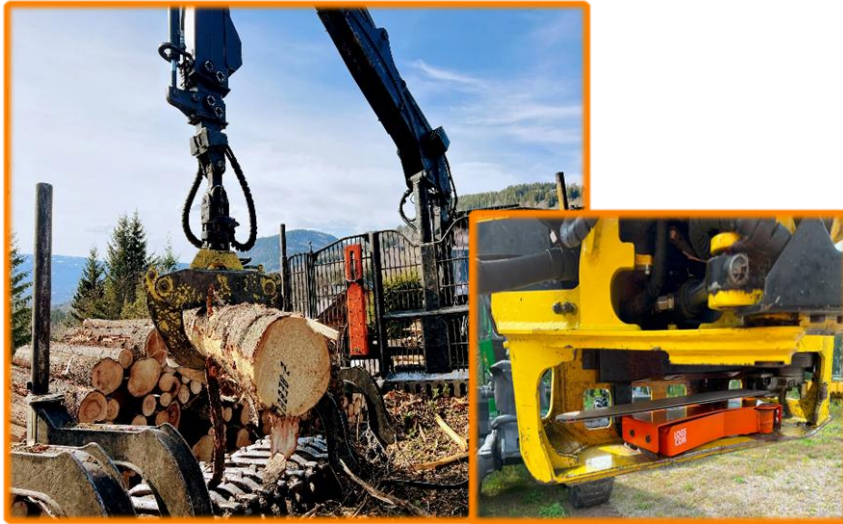
Abbildung 2: Logscom Forwarder-Modul am Rungenkorb, Harvester-Modul am Aggregat, von Lukas Stopfer
