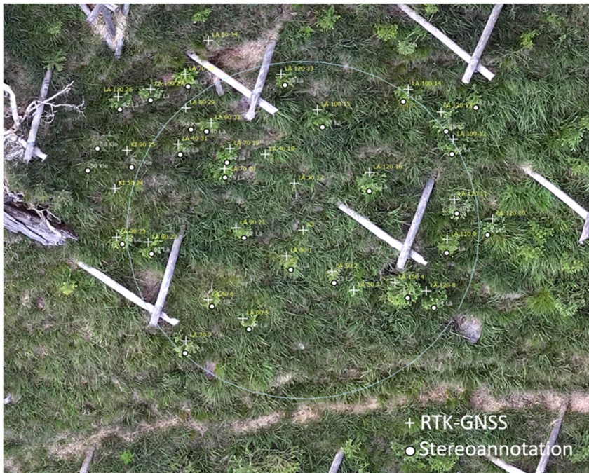
Abbildung 1: Stereoannotation am hochauflösenden Drohnenluftbild mit Lagerichtigkeit im sub-Dezimeterbereich zur Gewinnung von Trainingsdaten im Bereich der Baumverjüngung. Hier im Vergleich mit hochgenauer terrestrischer RTK-GNSS-Vermessung
