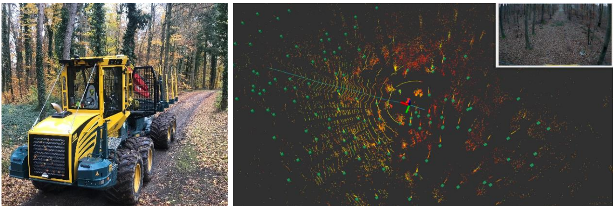
Abbildung 2: Positionsbestimmung und Pfadplanung auf Basis von Lidar- und IMU-Daten
